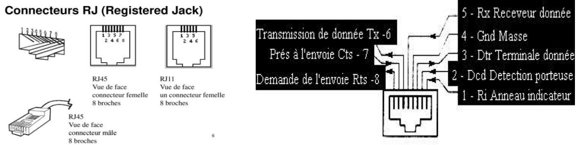
Figure. IV-8: Brochage du connecteur RJ45-8 broches (Femelle vue de face)[27]
