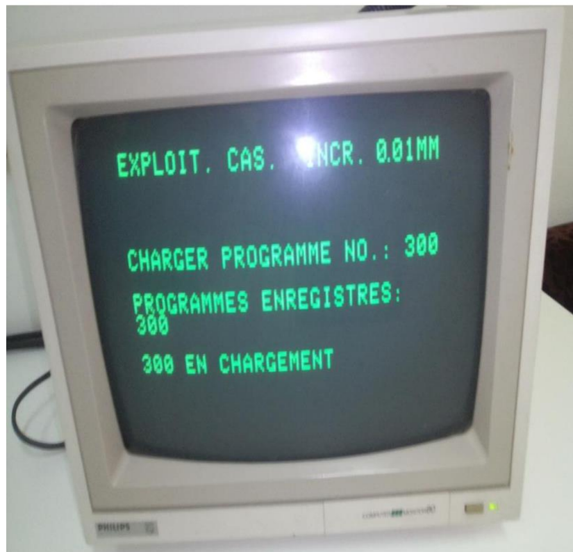
Figure IV.A: Exemple de transfert d'un programme G-code entre la cassette et la MOCN. (Avant la réalisation )
