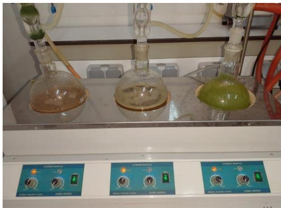
**Photo 4**: Appareil d'extraction par reflux
