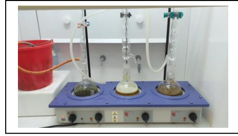
Extraction par méthode Soxhlet
