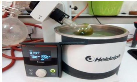
(4) Evaporation du solvant d'extraction par un rota évaporateur rotatif
