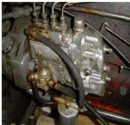
Figure II.20 : Exemple de pompe en ligne.
