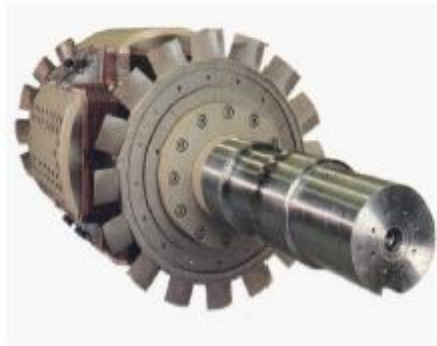
Figure II.35 : Rotor à pôle saillant. [12]
