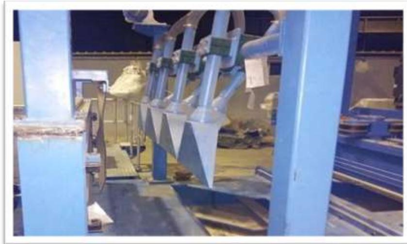
*Figure I-12 Nettoyage de feuillard.*
