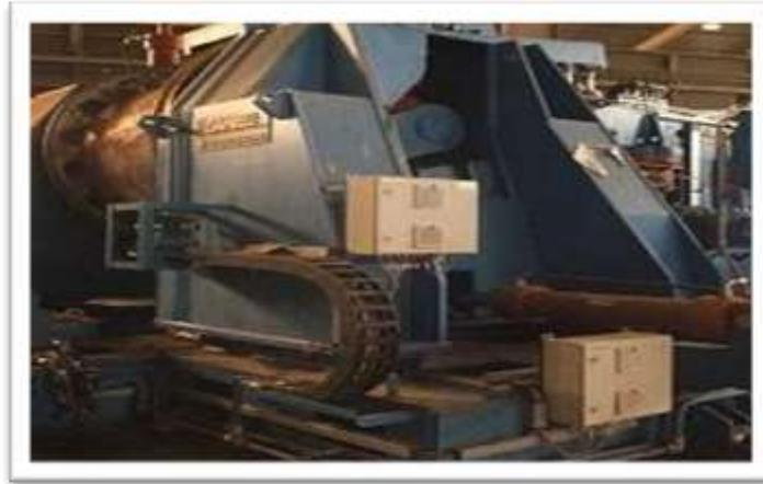
*Figure I-5 : Supports de bobine (dévidoir).*
