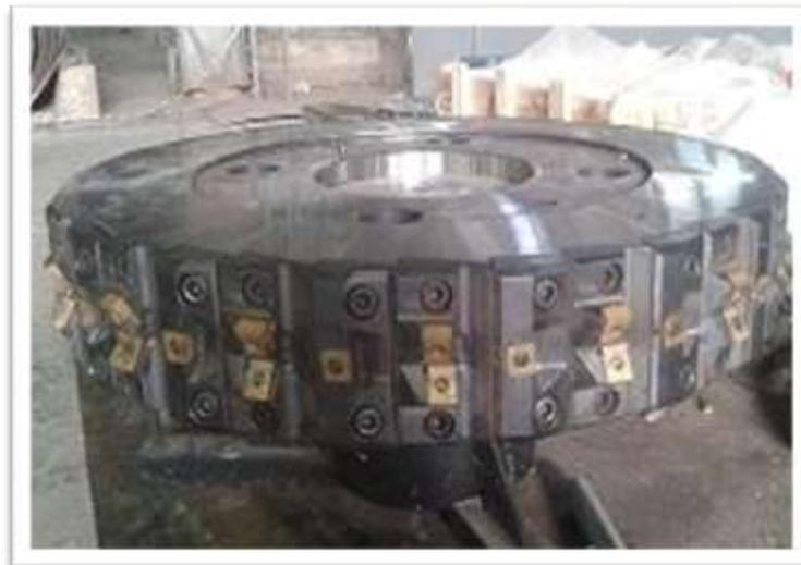
**Figure I-11** Fraiseuse de profil.**Nettoyage de feuillard:**
