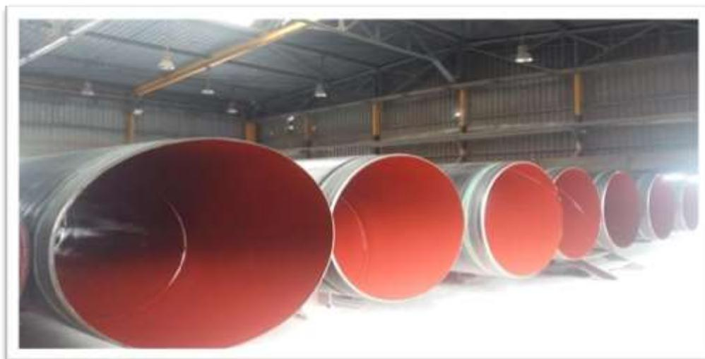
*Figure I-29: Revêtement extérieur et intérieur du tube.*
