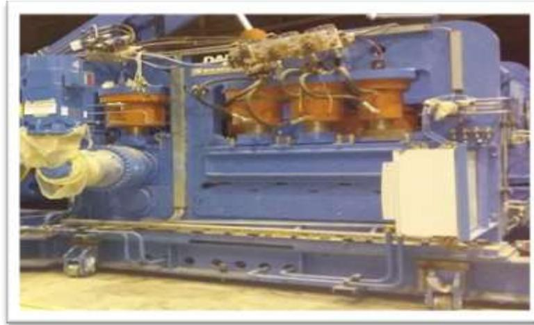
*Figure I-7: Dispositif de dressage.*
