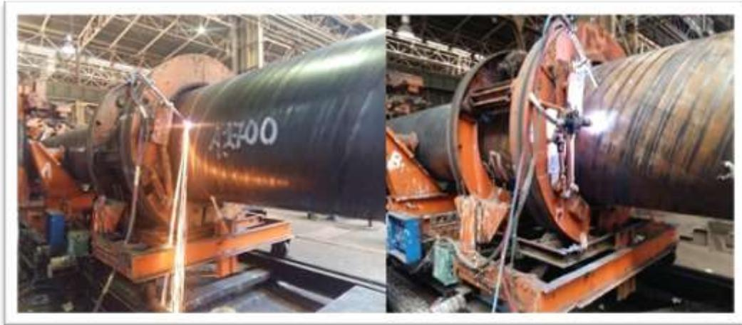
*Figure I-28 :Oxicoupage par chalumeur et par plasma*
