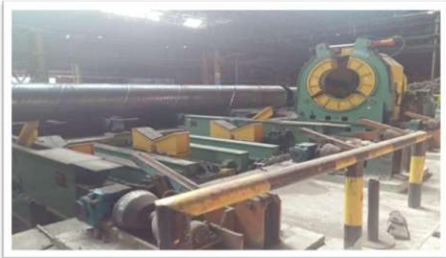
*Figure I-23: Vue de la chanfreineuse de tubes.*
