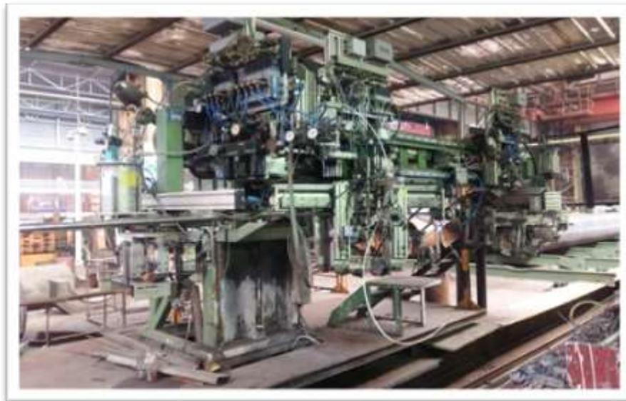
*Figure I-24: machine de contrôle ultrason automatique*
