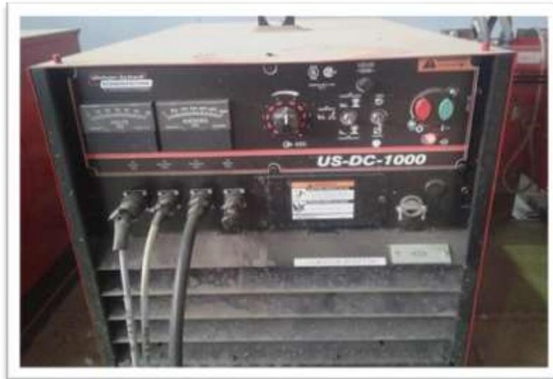
*Figure I-16 : Poste de soudage extérieur.*
