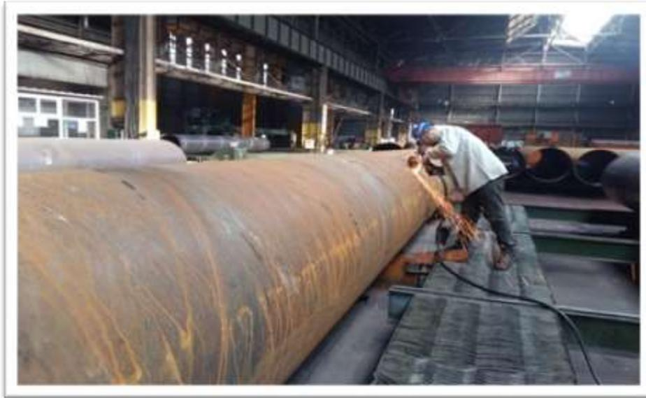
*Figure I-21 : réparation des défauts manuellement*
