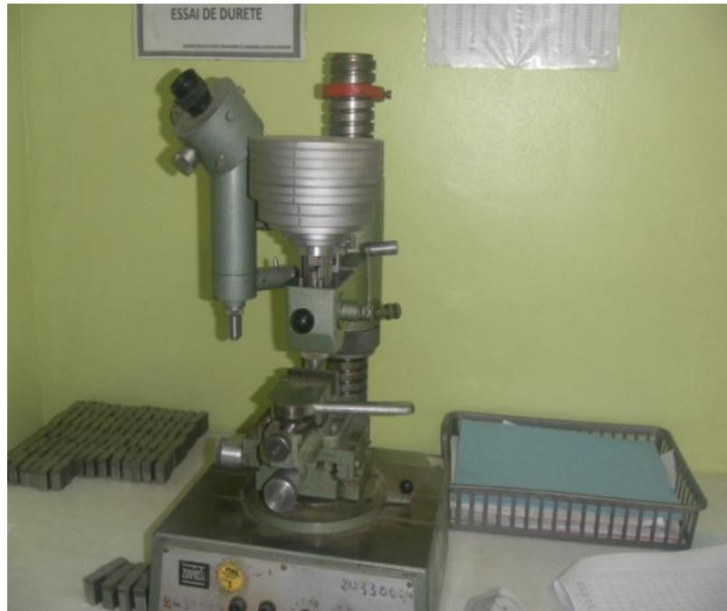
Figure IV.26 : Micro duromètre utilisée pour les mesures de la micro dureté (Type Vickers)
