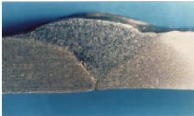
Figure IV.6 : Manque de pénétration et collage en bord du joint. [27]
