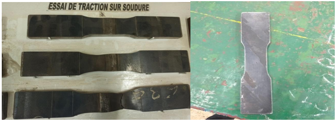
Figure IV.11 : Epreuve de traction : (a) contenant le cordon de soudure. (b) en métal de base
