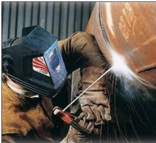
Figure III.18 : Soudage à l'électrode enrobée
