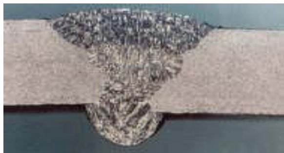
Figure IV.5 : Excès de pénétration [27]
