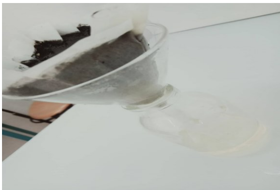
Photo IV.16 : Filtration de la solution
