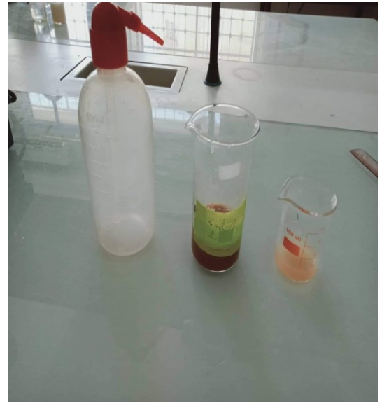
Photo IV.2 : Lavage du sable par l'eau distillée.
