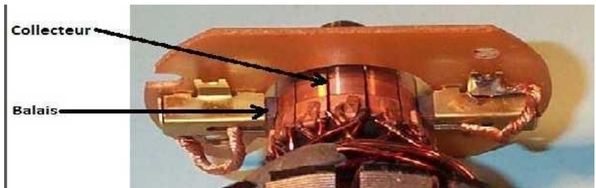
Figure (I.6) : Collecteur et Balais d'une machine à courant continu
