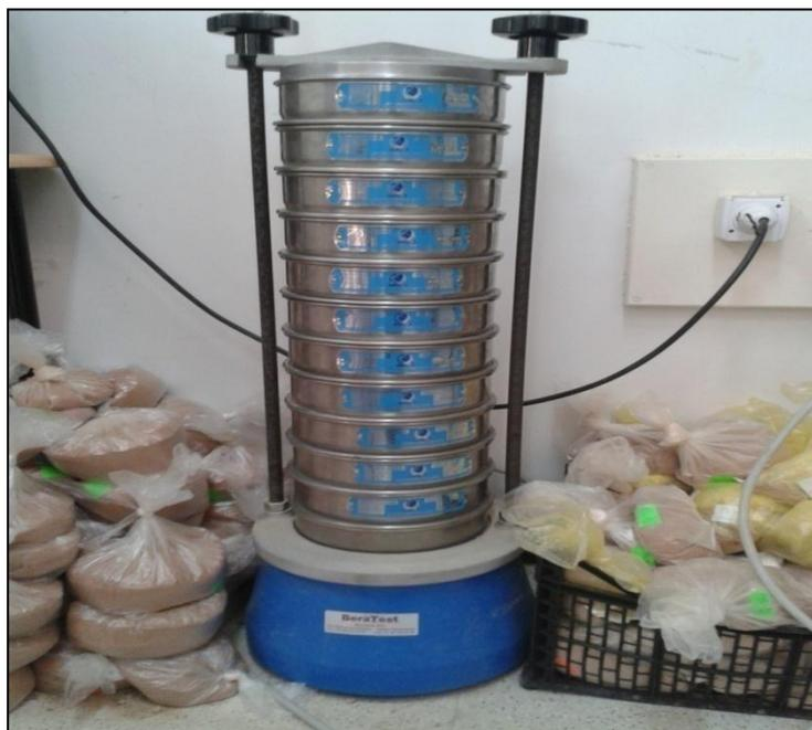
Figure N°44 Les tamis dans le vibreur
