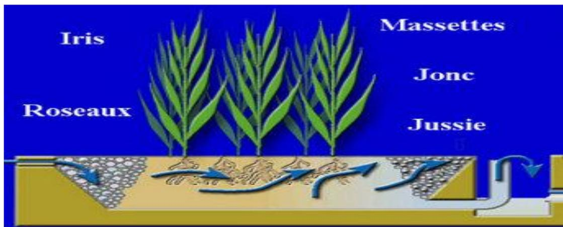
Figure(II.2) : coupe d'un bassin de lagunage.
