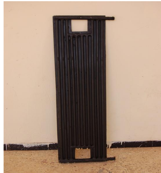
Figure (III.3) : tubes qui sont soudé Parallèlement sur plaque
