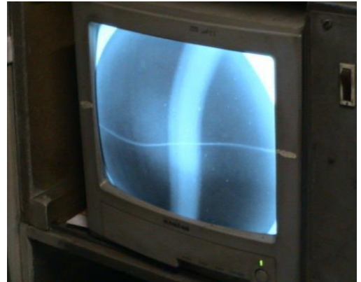
Figure VI.9 Contrôle de la soudure par radioscopie.
