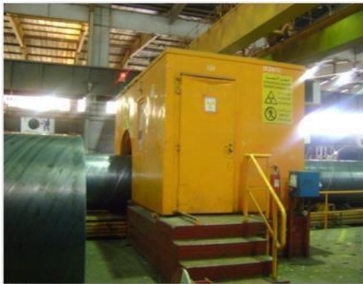
Figure VI.9 Contrôle de la soudure par radioscopie.
