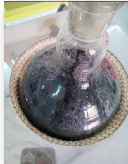
Photo N°10: Montage d'activation du CAND
