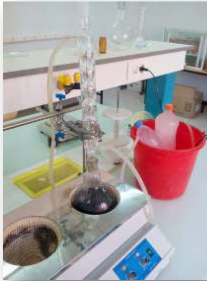
Photo N°10: Montage d'activation du CAND
