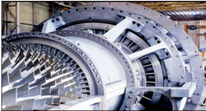
*Figure 13 : : Le corps de refoulement du compresseur.*
