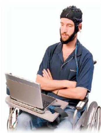
Figure I.09 : Un fauteuil roulant contrôlé uniquement par l'activité cérébrale [13].
