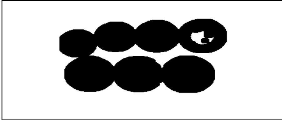
**Figure III.7:** dilatation de l'objet binaire en utilisant un élément structurant circulaire.
