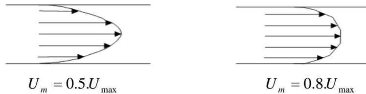
**Fig. II.20 :** Les profils des vitesses.
