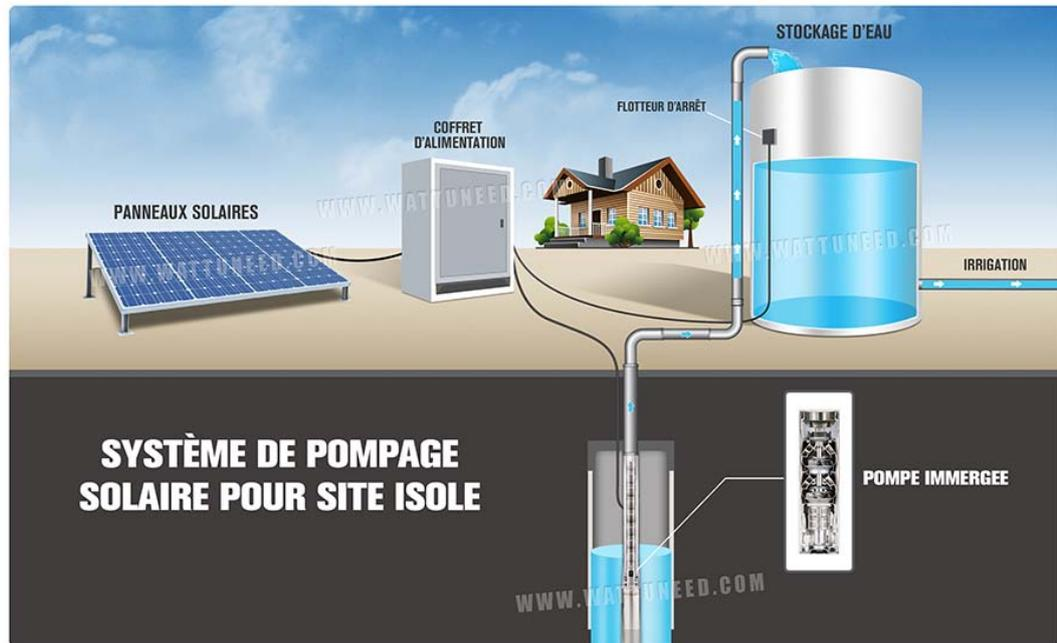
Fig. I.11 : Système de pompage solaire.
