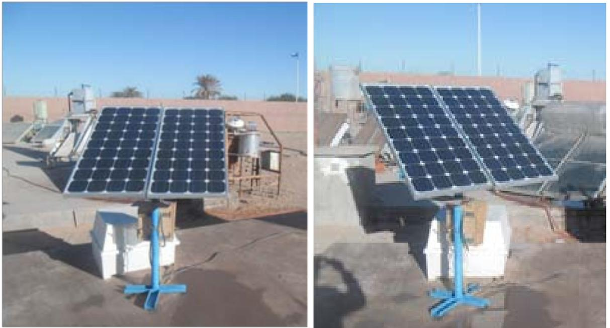
**Fig. IV.4 :** Différentes positions de système (Est, Ouest).
