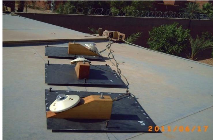
**Fig. III.4 :** Photo montrant l'installation des trois pyranomètres.
