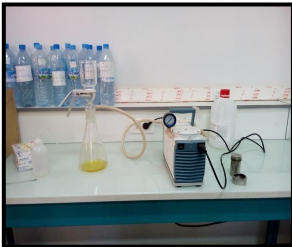
Photo N°5 : Filtration par pompe à vide
