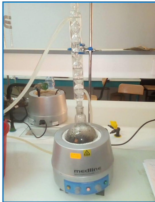
Figure-39 : Chauffe Ballon d'activation
