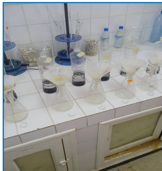
Figure-41 : Filtration après le traitement
