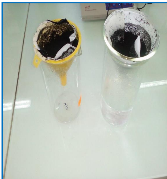
Figure-40 : Filtration de charbon actif
