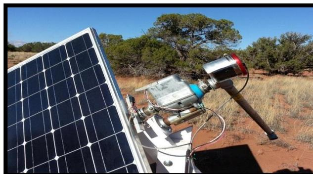
Figure : III.14: un moteur installé au suiveur solaire
