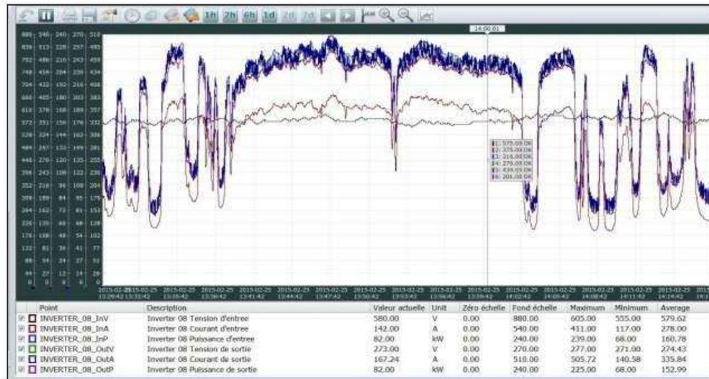
Figure (II.10): Fenêtre d'affichage des données par courbe.[16]
