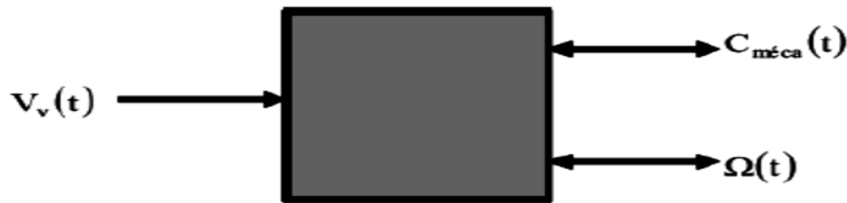
Figure IV 2: Entrées – sorties du modèle de la voilure.
