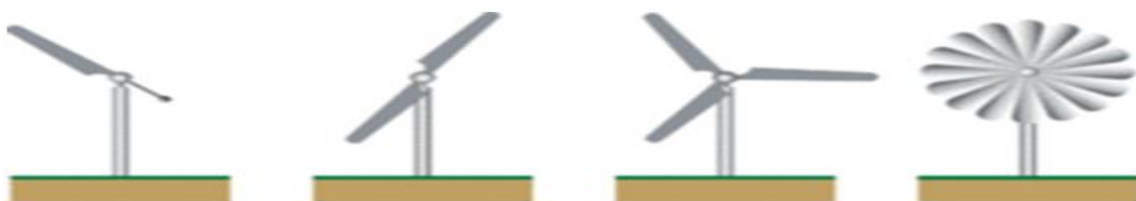
Figure I.23: Distinction entre éoliennes à axe horizontal selon le nombre de pales.
