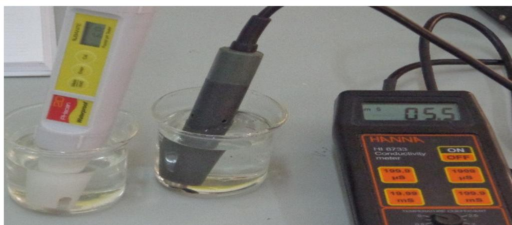
**Photo N°16 :** Mesure CE et PH de solutions du sol
