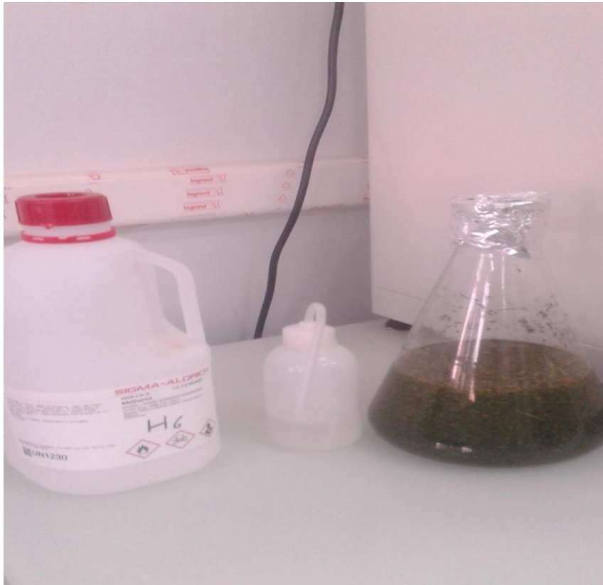
Figure13 : Extraction par macération ( le mélange eau- méthanol 30/70 (v/v) )
