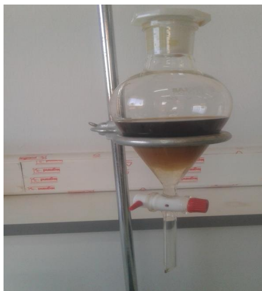
Figure14 : une extraction liquide/liquide dichlorométhane
