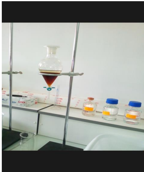
Figure 15 : une extraction liquide/liquide de l'éther de pétrole
