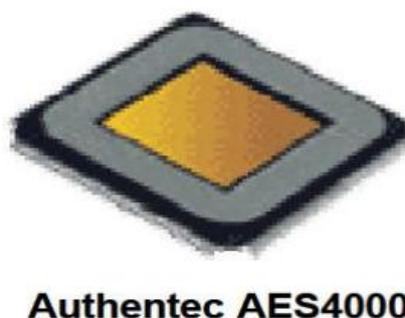
**Figure II-6** : Les capteurs électriques-thermique [5]
