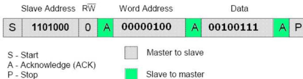
**Figure 2-22: Exemple d'écriture de données sur le DS1307 via I2C.**
