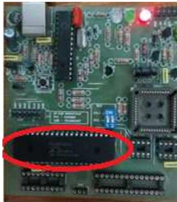
**Figure 4-16 : PIC18F45K22 placé dans le socle de flashage.**
