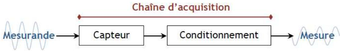
Figure 2-2 : Schéma de la chaîne d'acquisition d'une mesure.
