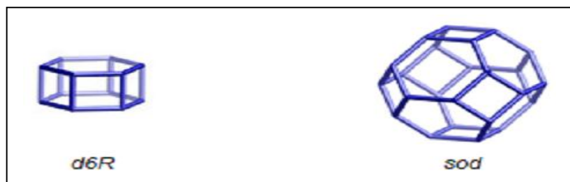
Figure I.11: Unités de construction dont l'assemblage régulier est à l'origine du type structural FAU-7 [41].
