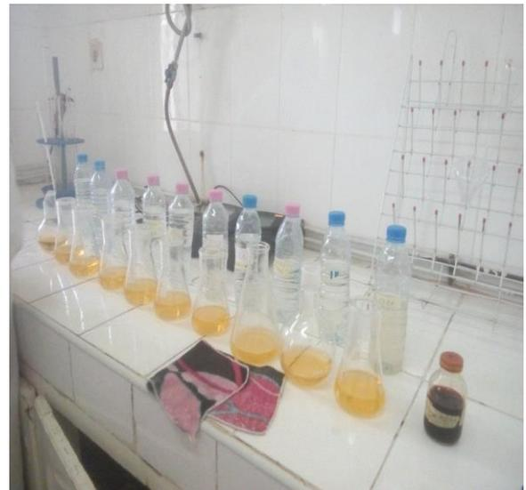
Photo : III-11 : Méthode volumétrique de TAC et TA (labo ADE Ouargla 2018).
