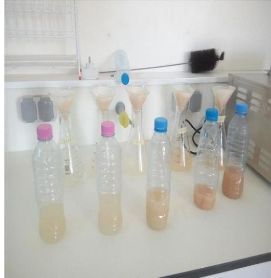
Photo III-8 : Agitation et filtration de l'extrait dilué 1/5
