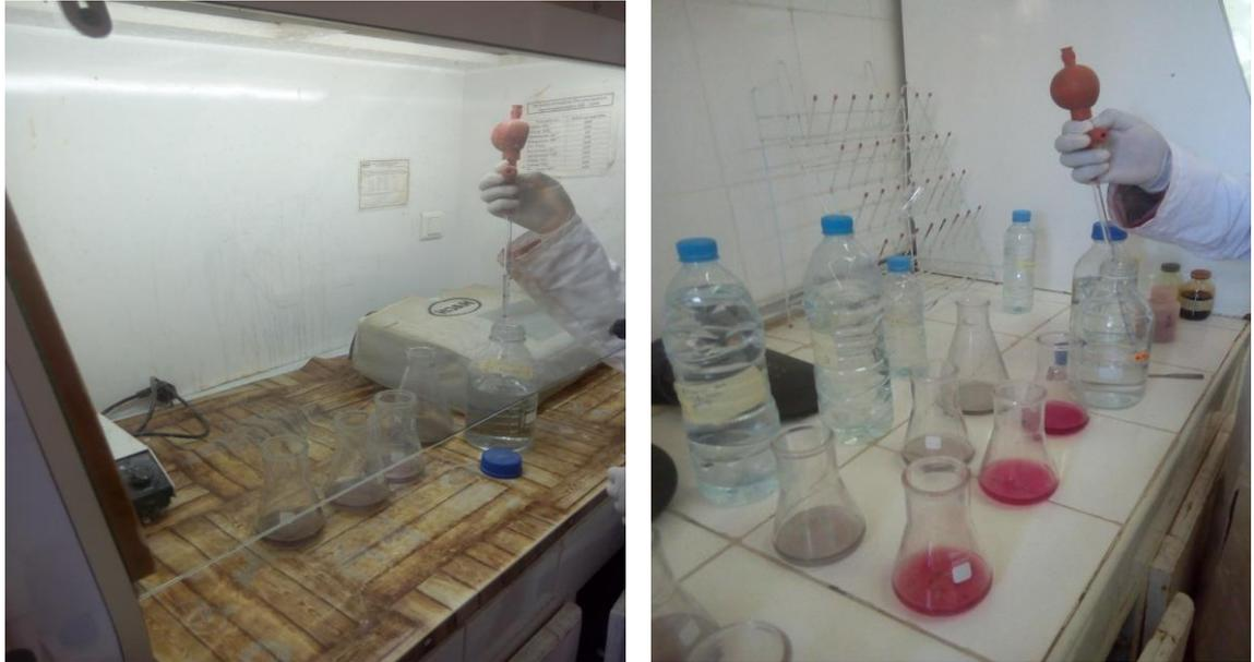
Photo III-13 : Méthode volumétrique de Calcium et Magnésium (labo ADE Ouargla 2018).
