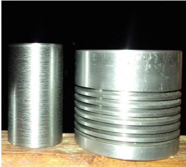
Fig.4.4. Chemise de piston réalisé.
