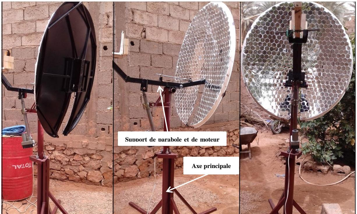
Fig.4.9. Différentes parties du système à concentration.
