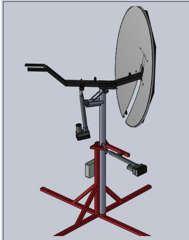
Fig.4.8. Conception mécanique du concentrateur sur SolidWorks.
