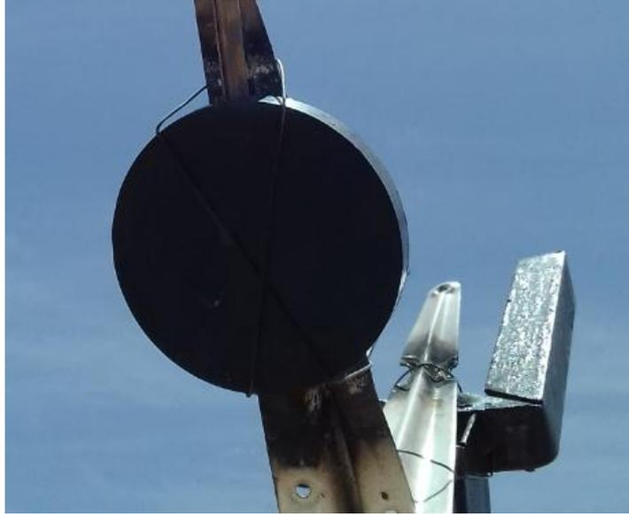
Fig.4.20. Plaque réceptrice au niveau du foyer du concentrateur parabolique.
