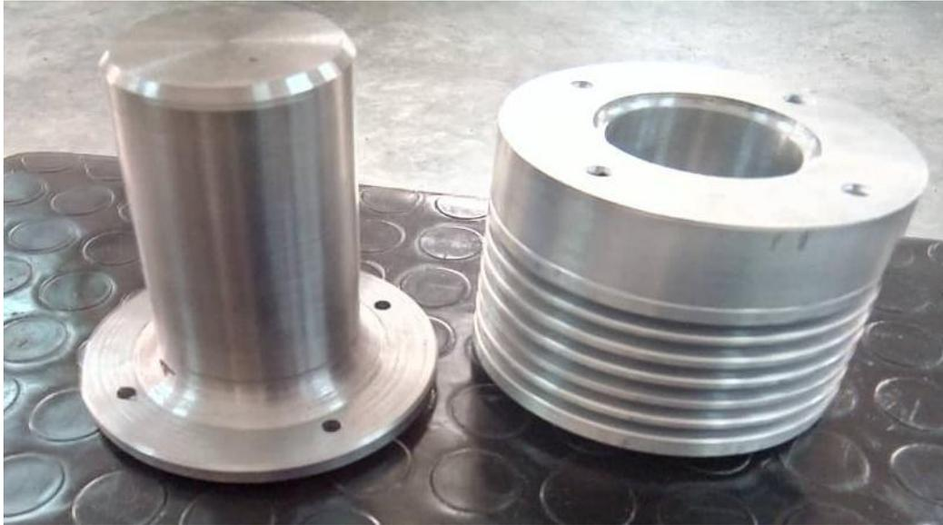
Fig.4.5. Cylindre de déplaceur réalisé
