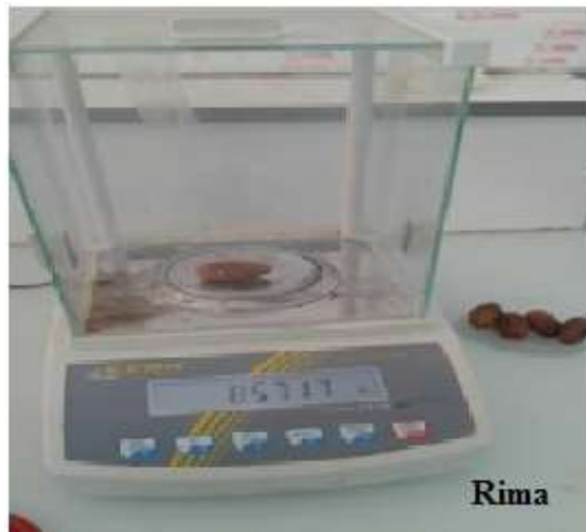
Photo 5: mesure de poids de DN à l'aide d'une balance analytique sensible
