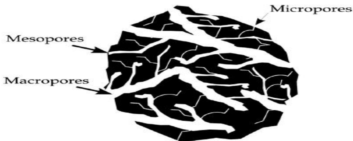
Figure 6 : Représentation schématique de la structure des pores de l'adsorbant (26).
