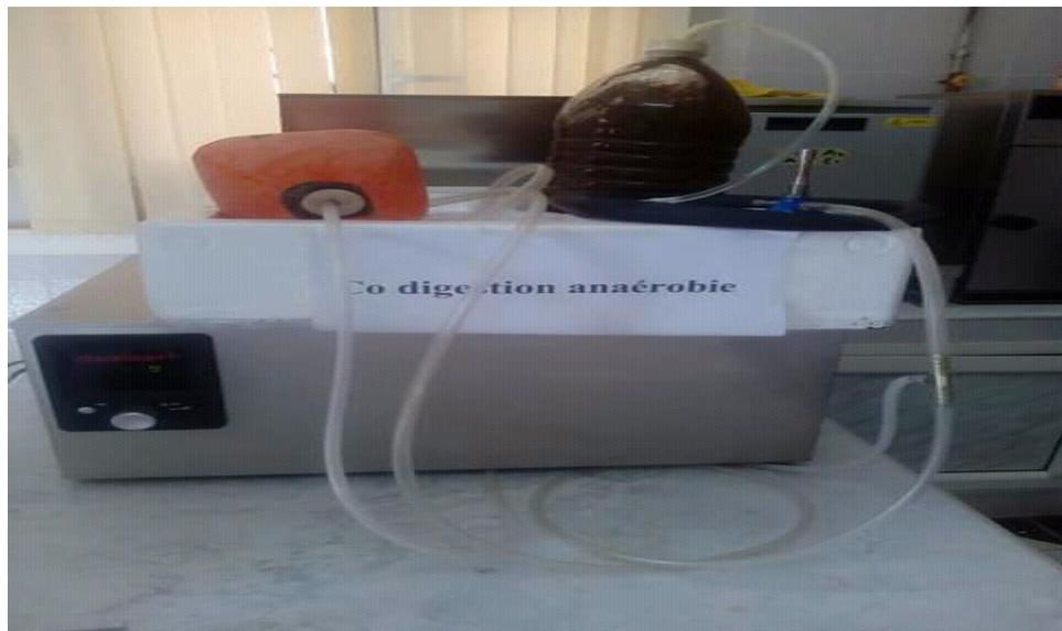
**Figure II.6 :** Photo du digesteur discontinu à l'échelle du laboratoire
