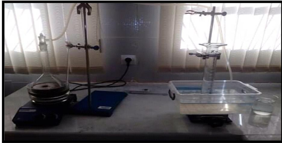
**Figure II.9 :** Photo du système de mesure du volume du biogaz produit
