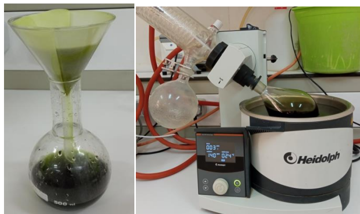
Figure N° 02 : Processus de filtration et d'évaporation de solvant
