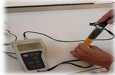
**Figure 29:** Mode opératoire de la conductivité électrique (Photo originale, 2022).
