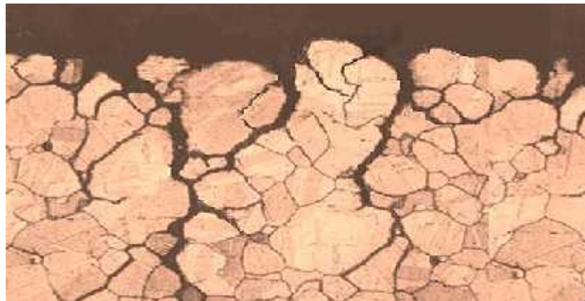
Figure I.VIII : Corrosion sous contraintes d'un alliage cuivreux. [07]
