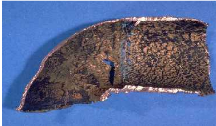
Figure I.VII : corrosion-érosion d'un tube en cuivre véhiculant de l'eau. [07]
