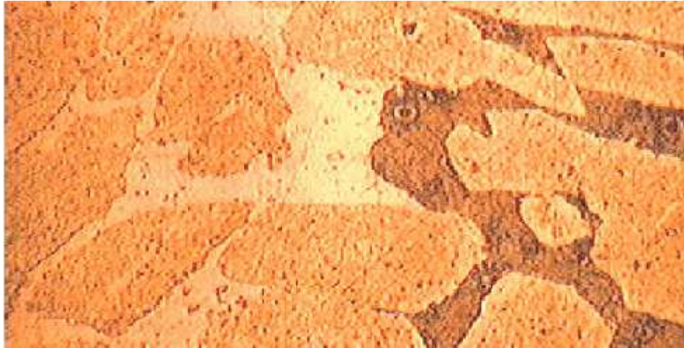
Figure I.VI : Coupe métallographique montrant une corrosion sélective d'un laiton. [07]
