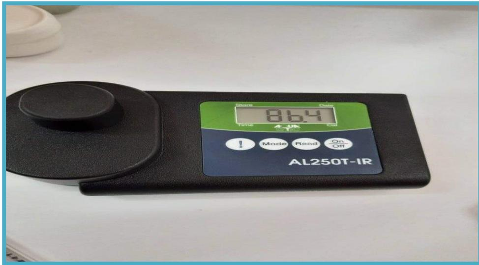
Figure 8: Turbidimètre de type AL250T-IR
