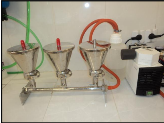
Photo 10: Pompe à vide
