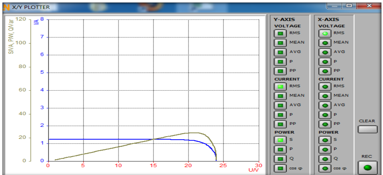
Figure (III.43) : caractéristique S/V parallèle ombrage
