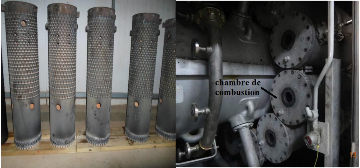
Figure III.5 : Chambres de combustion
