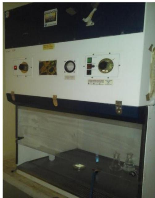
**Photo N°12** : Hotte à flux laminaire de type vertical
