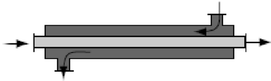
Figure III. 11 : Circulation à contre-courant
