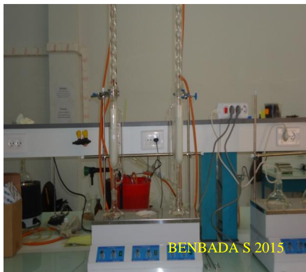
Photo 06.- Montage d'extractions par extracteur soxhlet (huiles fixes)
