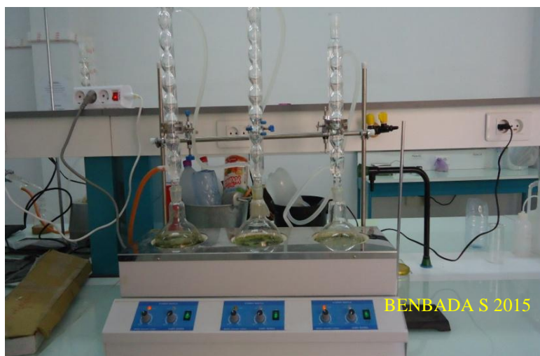
Photo 05.- Montage d'extractions par reflux (extrait aqueux)
