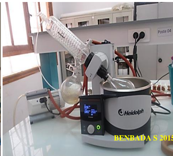
Photo 07.- Séparation d'huile fixe par rotor vapor
