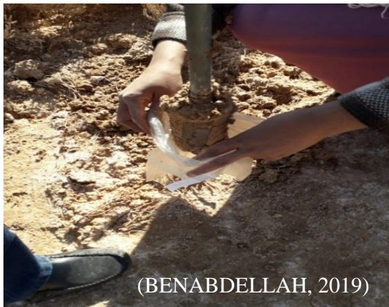
Photo 04: Prélèvement du sol par la tarière Manuelle (BENABDELLAH, 2019).
