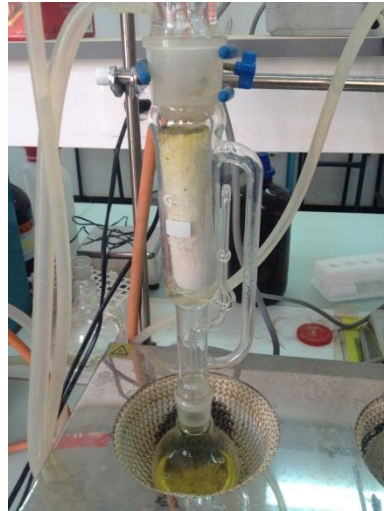
Photo17 : Appareil de Soxhlet au cours d'extraction.
