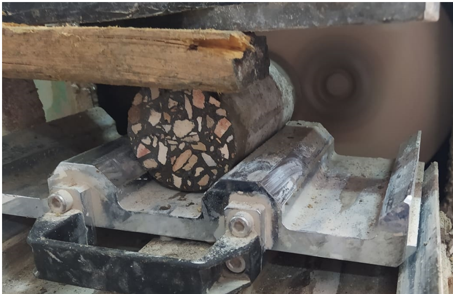
Figure II.13– surfaçage d'une éprouvette.
