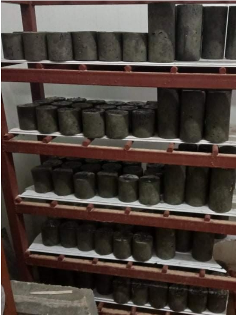
Figure II.10 – la cure des éprouvettes.
