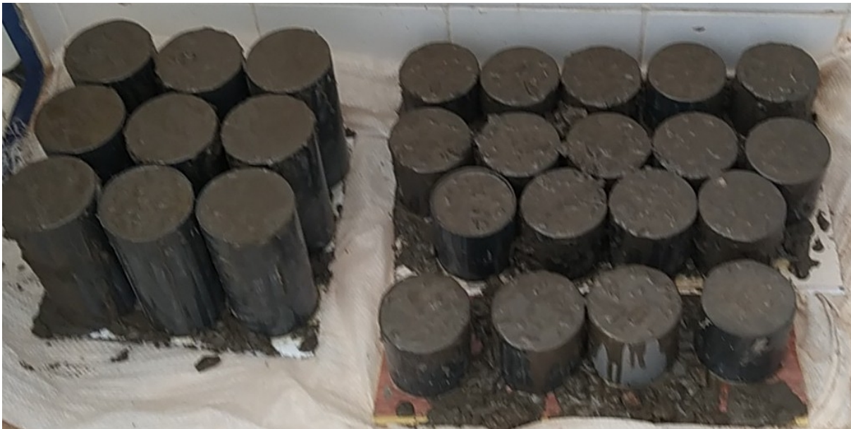
Figure II.9. Confection des éprouvettes du béton
