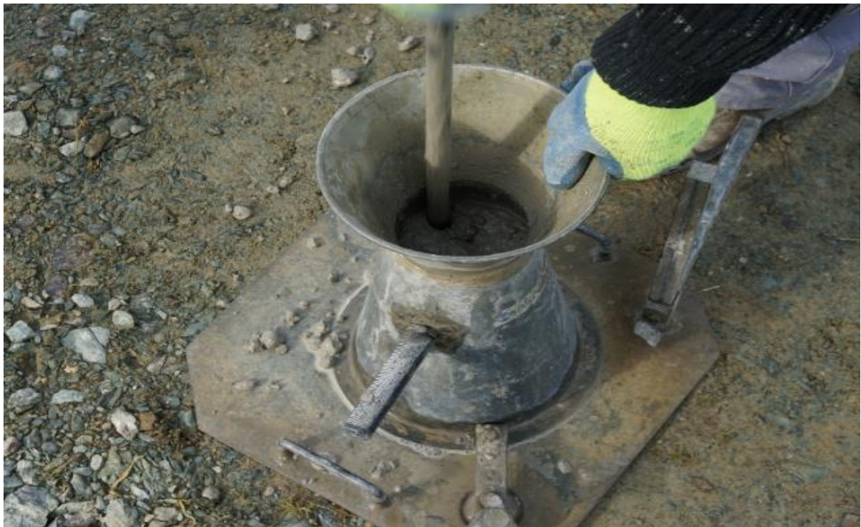
Figure II.11-l'essai d'affaissement au cône d'Abrams
