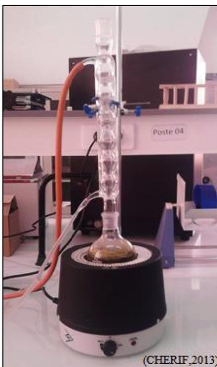
**Photo 10-** Dispositif d'extractions des principes actifs par reflux.
