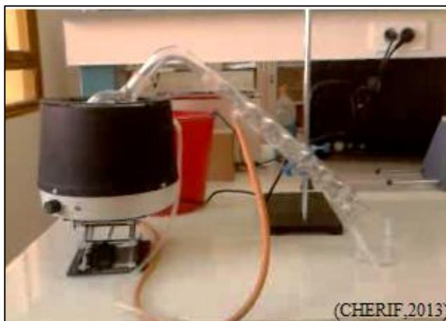
**Photo 11-** Dispositif d'évaporation de Méthanol.
