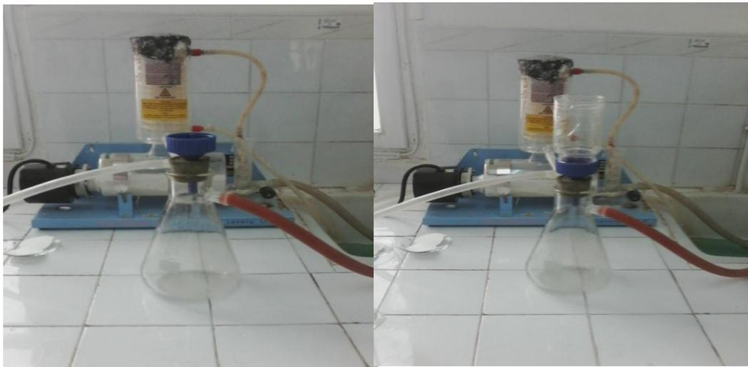
**Figure19:**Analyse de la matière en suspension
