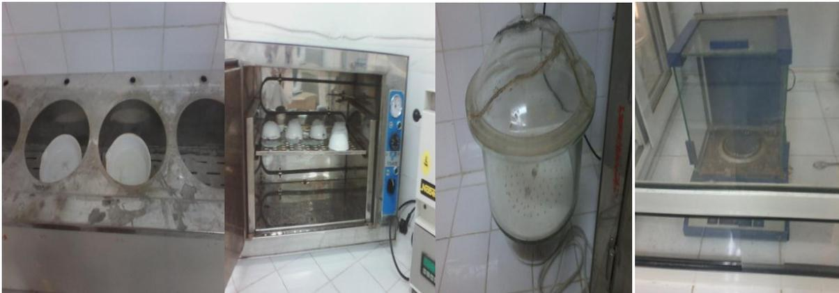
**Figure18:** Matériel utilisé pour l'analyse de résidus secs
