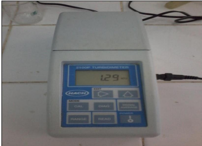
**Figure. 13:** Turbidimètre de paillasse.
