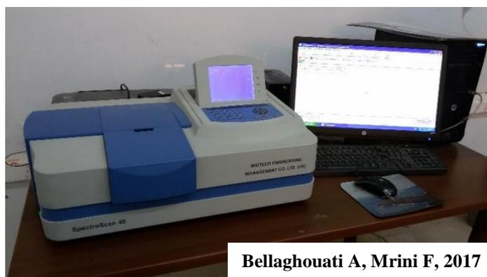
**Photo 5:** Spectrophotomètre UV-Visible (BIOTECH ENGINEERING MANAGEMENT CO. LTD. (UK)).
