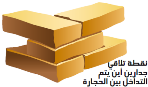
الشكل 9: يوضح الشكل تقنية تشريك الحجارة ديوان حماية التراث المزابي وترقيته
